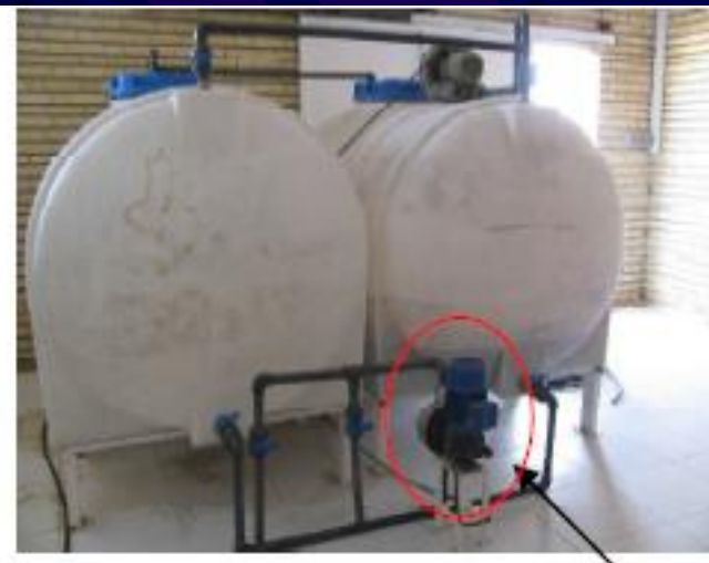
مخزن های کود با تزریق کننده ضربه ای و دمنده هوا جهت هم زدن و انحلال کامل کود
