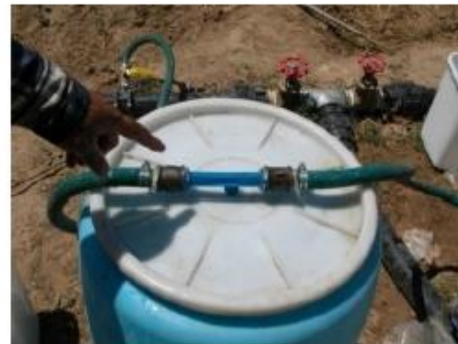
- استفاده از شیر ونتوری برای تزریق کود
