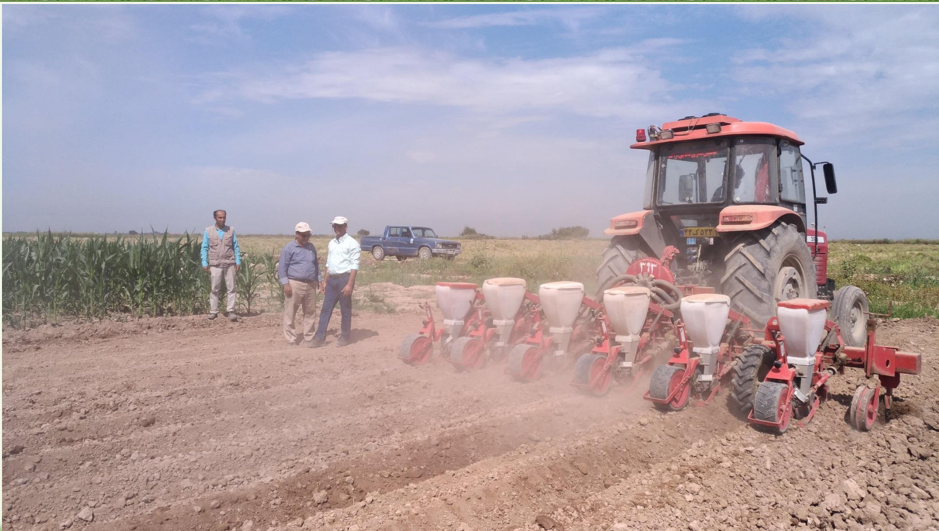
ردیف کار بادی (پنوماتیکی) با شش واحد کاشت
