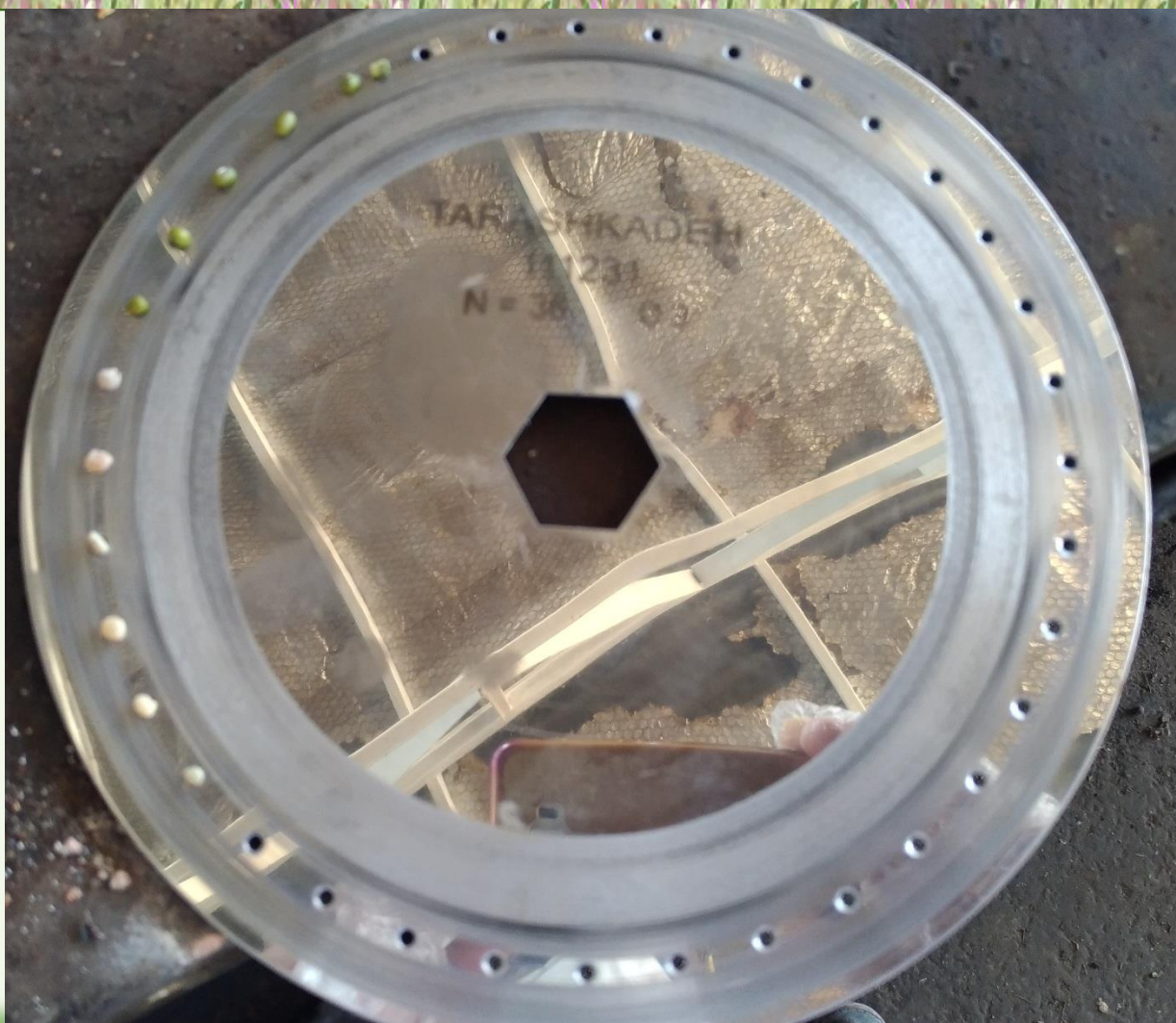
صفحه بندر ۳۸ سوراخ، قطر ۳ میلیمتر ردیف کار بادی
