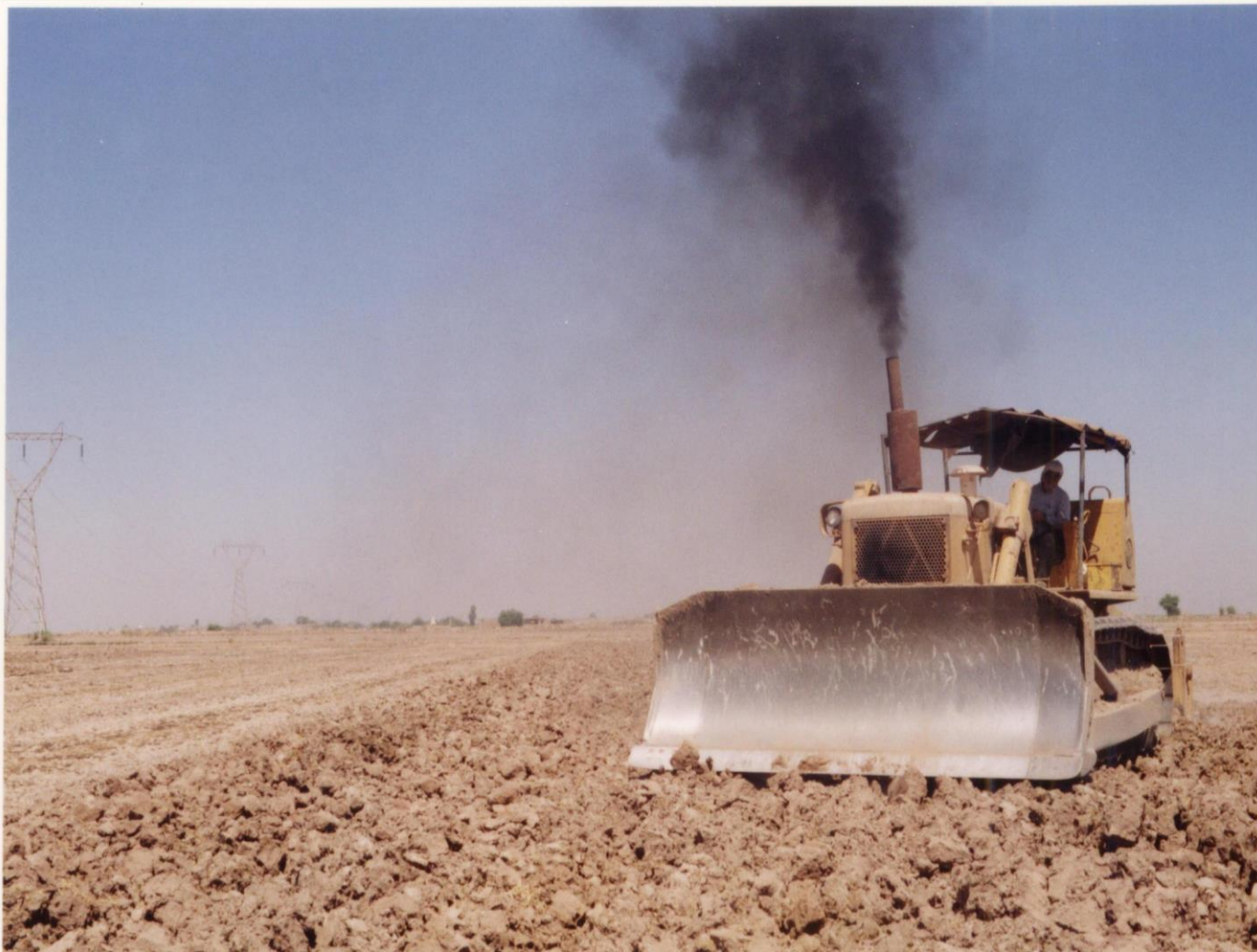
مرحله دوم ریپر در خاک خشک با زاویه مشخص
