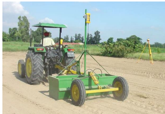
شکل ۲۵ - تسطیح زمین توسط لولر لیزری
