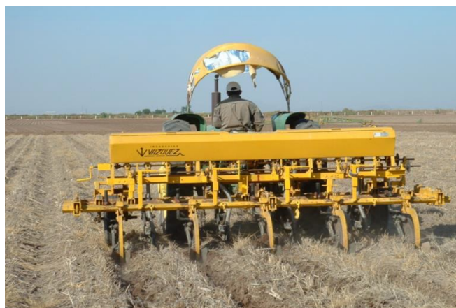
شکل ۲۷ - بهبود دهنده های جویچه ها در پشته های ثابت
