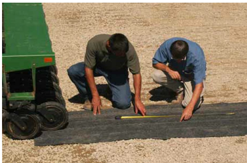
شکل ۲۴ - کالیبره کردن بذر کار در شرایط واقعی مزرعه و مشاهده یکنواختی و نحوه ریزش بذر
