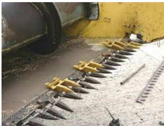
شکل ۳۰ - برخورد تیغه‌های کمباین به مرزها در آبیاری مرسوم (راست) و شکستن مکرر تیغه شانه برش کمباین (چپ).
