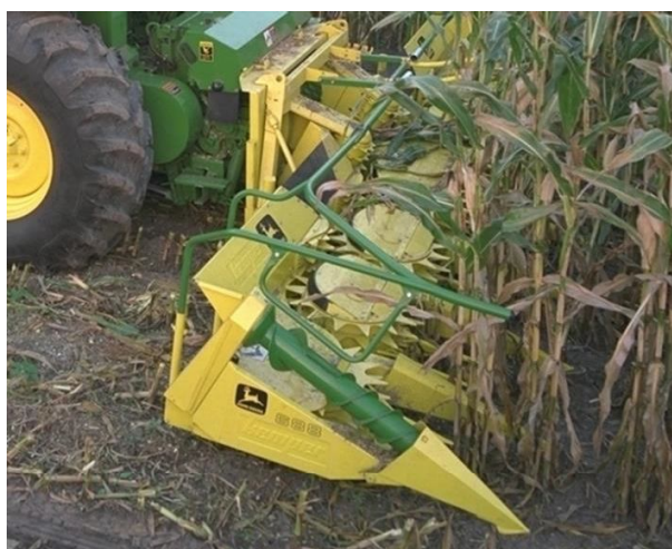
شکل ۱۸ - چابر مستقل از فاصله ردیف، برای رفع محدودیت ابعاد پشته های بلند گندم در تناوب با ذرت علوفه ای
