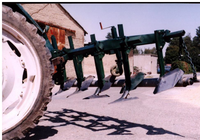
شکل ۷- خاک‌ورز مرکب مورد استفاده در روش کاشت روی پشته‌های بلند
