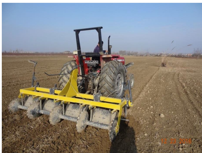
شکل ۱۲- فاروئر غلطکی که برای ایجاد بستر و شیار در بار اول در مزرعه از آن استفاده می شود.
