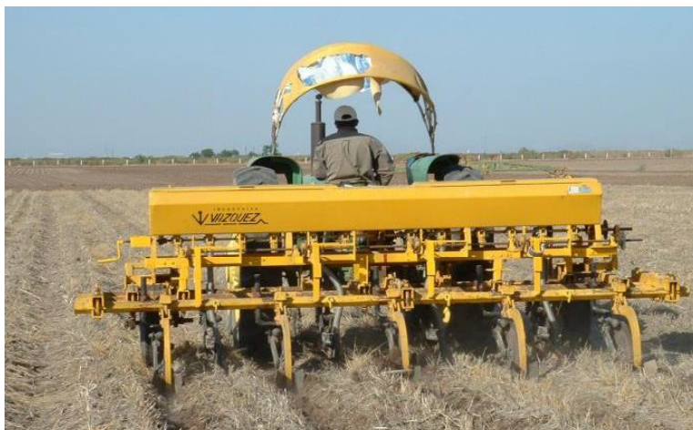
شکل ۳- شکل دادن مجدد به شیارها با فاروهای آبیاری در سامانه بسترهای بلند بدون تخریب بسترها.
