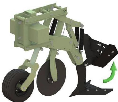
شکل ۲۹- کولتیواتورهای مخصوص، مجهز به چرخ فشاری کف جوی و تیغه های جانبی برای افزایش نفوذ جانبی آب نسبت به نفوذ عمقی
