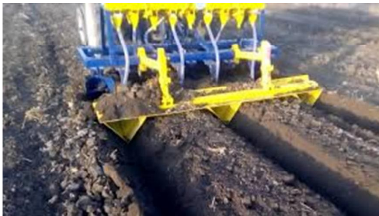
شکل ۲۶ - کمبینات مجهز به شیپر قابل تنظیم
