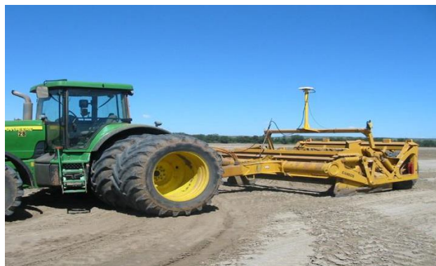
شکل ۲۵ - تسطیح زمین توسط لولر لیزری
