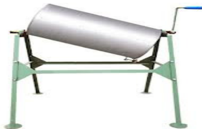
تصویر ۲: محفظه دوار برای بذر مال کردن بذور.
