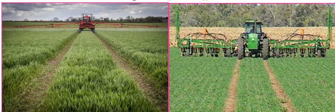
شکل ۵- استفاده از روش رفت و آمد در راهروهای ثابت برای انجام عملیات داشت (حرکت چرخ تراکتور در مسیر تردد ماشین‌های قبلی)
