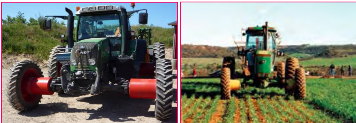
شکل ۱۴- افزایش طول اکسل تراکتور با قرار دادن قطعات رابط برای ایجاد امکان حرکت چرخ تراکتور از راهروهای ثابت
